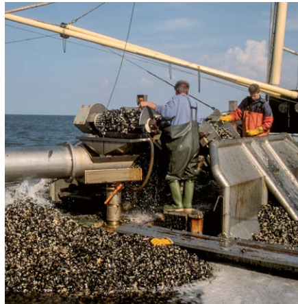
Bei den moderneren Kuttern gelangt der Fang über Transportbänder auf eine Spülanlage.
