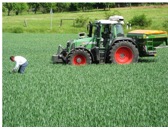
Bild 7: Düngerstreuer mit N-Sensor zur bedarfsgerechten Stickstoffdüngung
