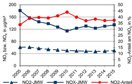
Abb. 5.1: Jahresmittelwerte für  $\text{NO}_2$  und  $\text{NO}_x$  an der Verkehrsstation Osnabrück
