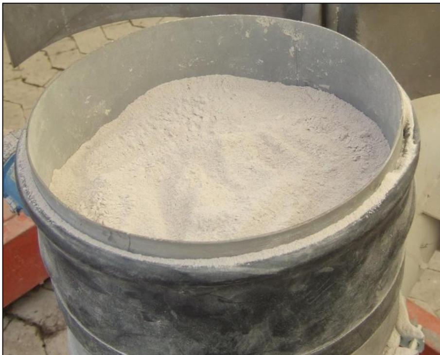
Abbildung 24: Aufnahme der auf der Kläranlage Hildesheim verwendeten CSH-Partikel, mit dem Produktnamen PORYLIT® 0 – 0,7 mm
