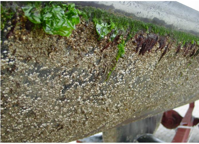
Abb. 2 Typischer Salzwasserbewuchs. Ein Boot, das so bewachsen ist, kann nur noch an Land gebracht und der Bewuchs abgestochen werden.
