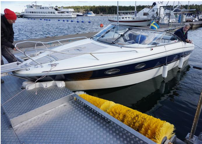
Abb. 9 Raue, noppenbesetzte Folie für Motorboote zur Befestigung am Liegeplatz. Beim An- und Ablegen wird der Rumpf immer wieder automatisch gereinigt.
