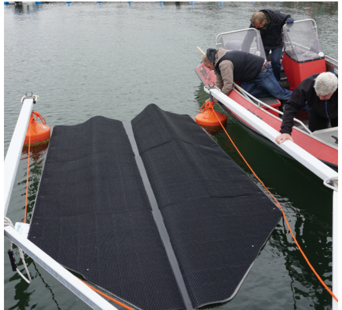
Abb. 9 Raue, noppenbesetzte Folie für Motorboote zur Befestigung am Liegeplatz. Beim An- und Ablegen wird der Rumpf immer wieder automatisch gereinigt.
