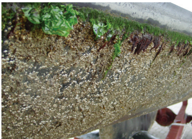
Abb. 2 Typischer Salzwasserbewuchs. Ein Boot, das so bewachsen ist, kann nur noch an Land gebracht und der Bewuchs abgestochen werden.
