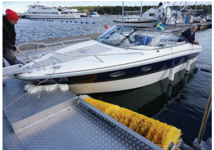
Abb. 10 Stationäre Waschanlage an der schwedischen Küste
