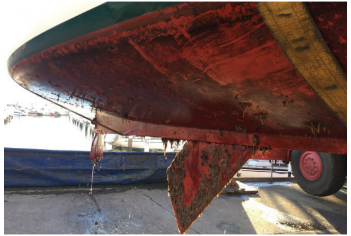
Abb. 5 Jollenkreuzer mit Silikonbeschichtung, typische, schwach haftende Bewuchsgemeinschaft am Saisonende
