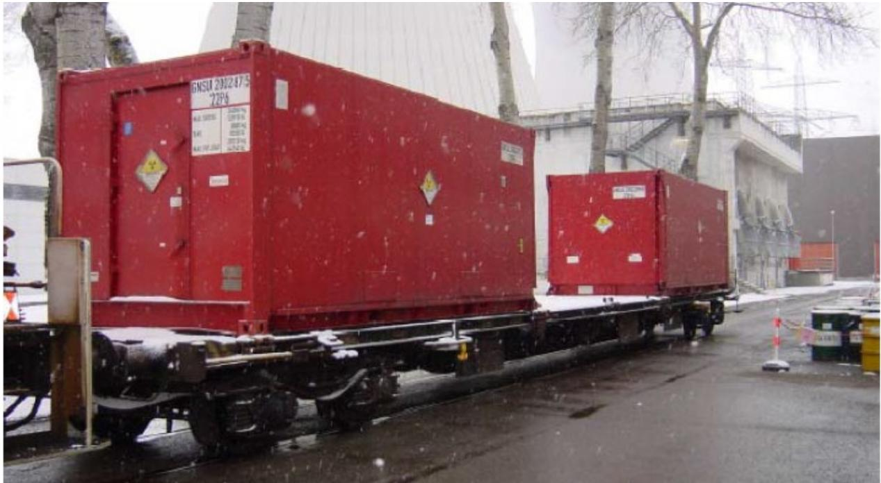
Abbildung 8 Tragwagen für Großcontainer/Wechselbehälter der Baureihe Sgjs 712. Quelle: GRS-Transportstudie 2009 /U 3/, Abb. 6.7
