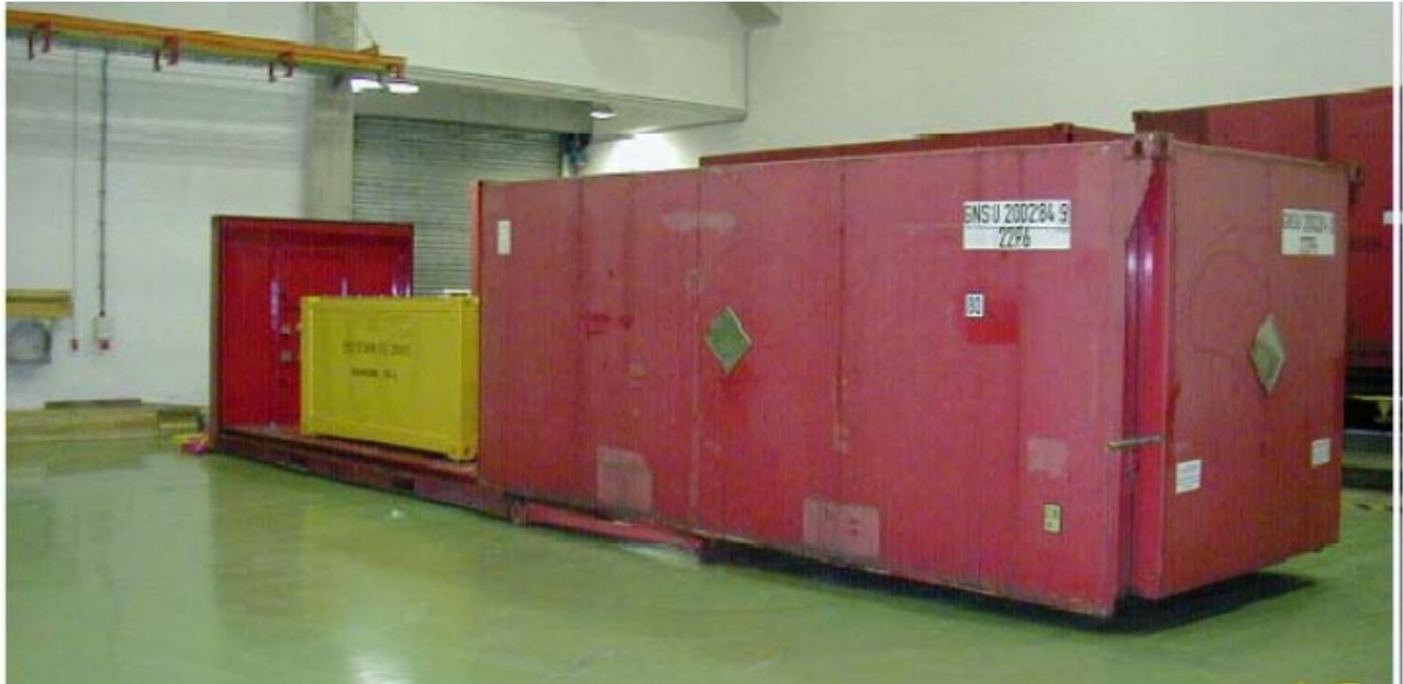
Abbildung 6 Abfalltransportcontainer (Typ IP-2) – 20'-Open-all-Container. Quelle: GRS-Transportstudie 2009 /U 3/, Abb. 6.5
