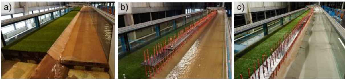
Abbildung 18: Versuchsanordnungen: a) feste Sohle, b) feste Sohle und Uferbewuchs c) mobile Sohle und Uferbewuchs
