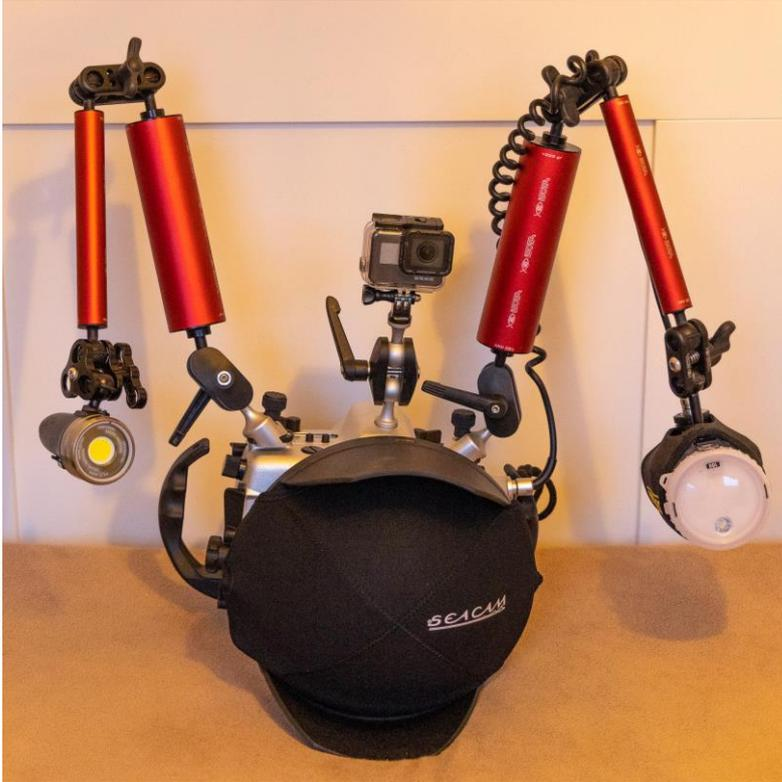
**Abb. 5:** Kamera-Setup der Spiegelreflex-Kamera mit mittig montierter GoPro 7, einem Blitz für die Rahmenfotos (rechts, Sea&Sea YS-D2) und einer Videoleuchte (Sola 3800) für die Megafauna-Transecte.
