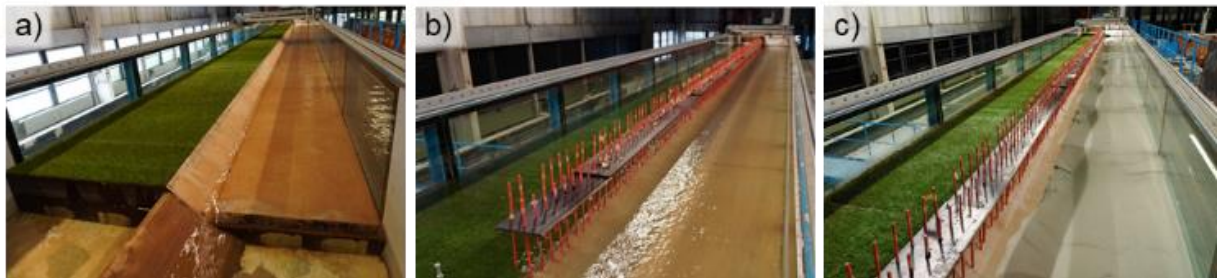
Abbildung 18: Versuchsanordnungen: a) feste Sohle, b) feste Sohle und Uferbewuchs c) mobile Sohle und Uferbewuchs
