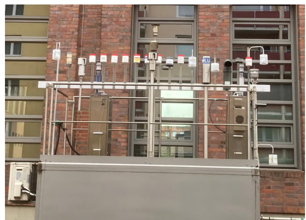
Abbildung 2.2: Verkehrsmessstation Hannover mit NO 2 -Passivsammlern
