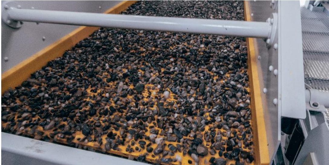
Nassklassierung unter mehrstufiger Bedüsung mit Frischwasser
