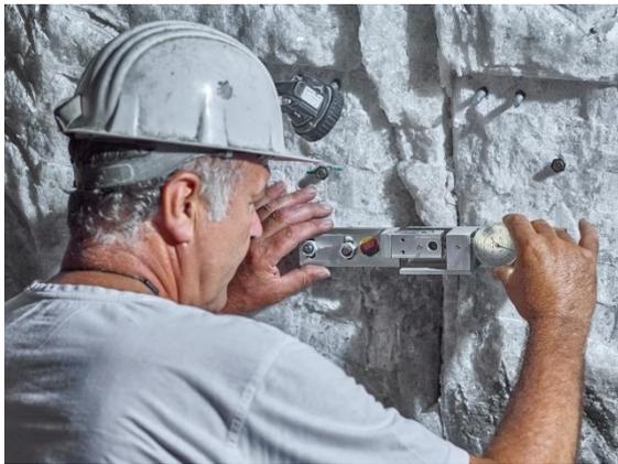
Abbildung 3: Spaltüberwachung unter Tage, Foto: BGE
