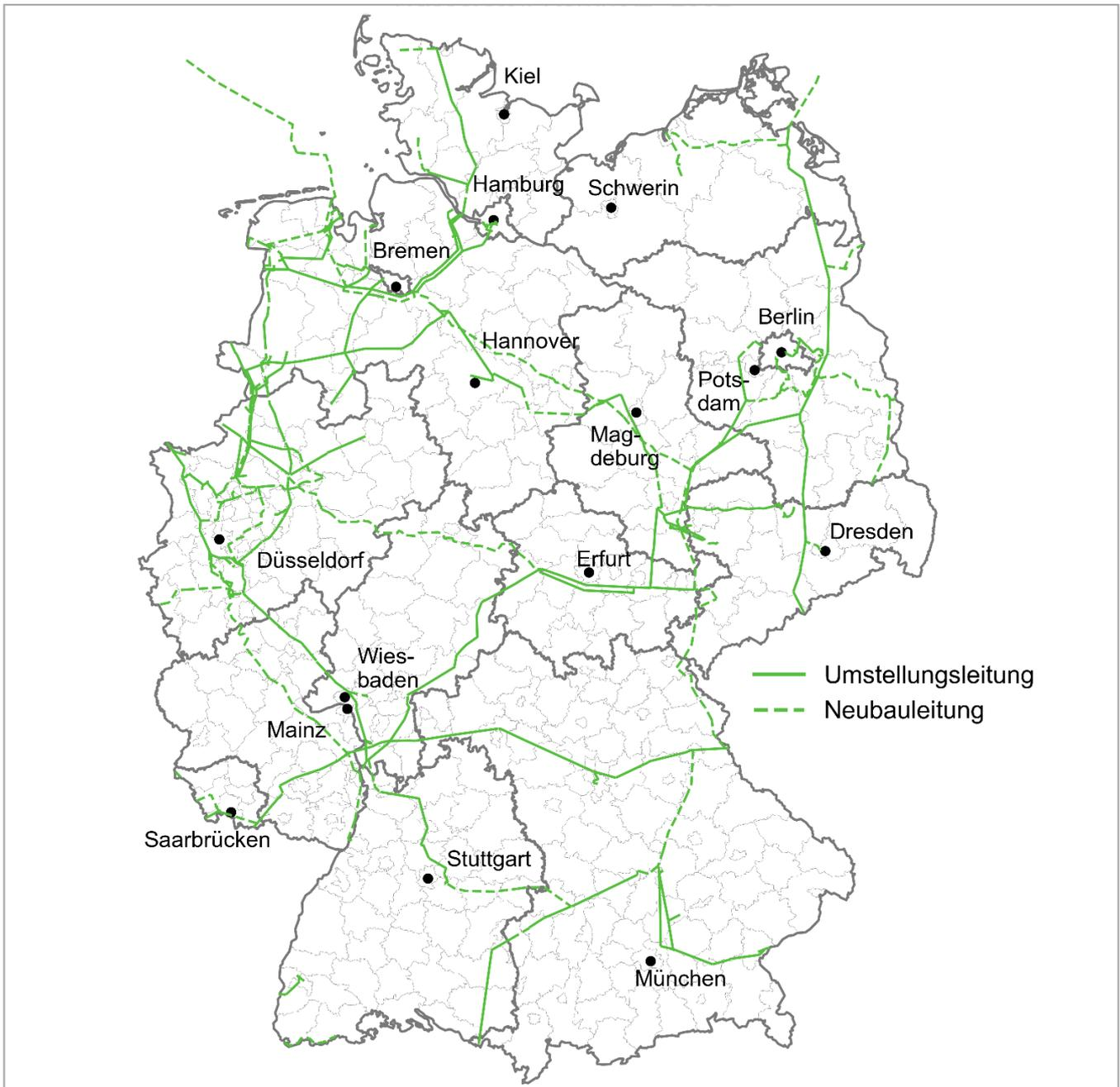
Abbildung 22: Entwurf für das Wasserstoff-Kernnetz; Stand Oktober 2024
