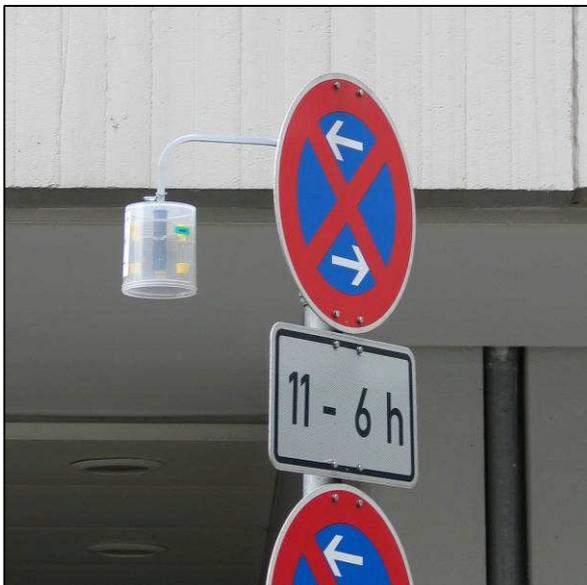
**Abb. D1:** An einem Verkehrsschild installierter NO<sub>2</sub>-Passivsammler
