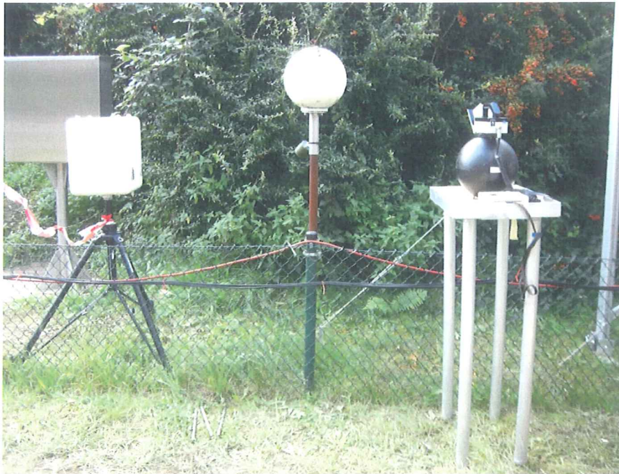
Messaufbau mit dem von der PTB eingesetzten Neutronen-Ortsdosisleistungsmessgerät (rechts) und dem Messgerät für Gammastrahlung (links) in unmittelbarer Nähe der Neutronendosis-Messstelle Nr. 12 (weiße Kugel).
