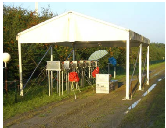
Abbildung 2: Messaufbau mit NEMUS am nördlichen Zaun des TBL. Links: Blick in eine geöffnete Aluminiumkiste mit der 12" Kugel mit eingebautem ^3\text{He} Zähler und Elektronikmodul. Rechts: sechs parallel betriebene Kugeln in Aluminiumkisten unter dem Zelt, direkt am Zaun in 1 m Höhe über dem Boden. Auf dem Bild zusätzlich zu sehen: Kabeltrommeln für die Stromversorgung der Elektronikmodule (unter den roten Plastikplanen), links die 30 cm Messkugel des NLWKN (Messstelle Nr. 12) und im Hintergrund der PTB LB6411 (unter der blauen Plastikplane).
