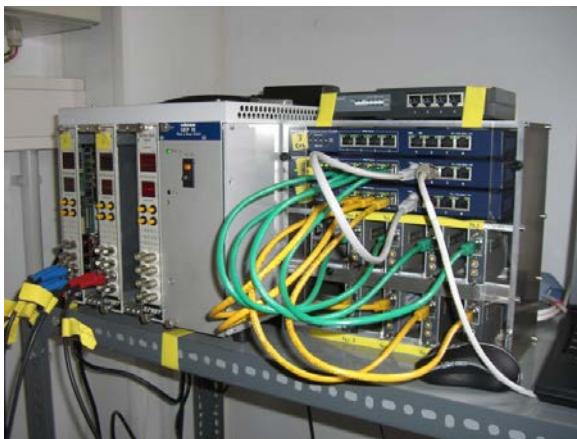
Abbildung 3: Messaufbau mit NEMUS am nördlichen Zaun des TBL (Fortsetzung). Links: Module für die Datenaufnahme im Messhaus 2: zwei 4-fach ADC, ein Vielkanalanalysator pro Datenzweig inkl. Ethernet-Switches. Rechts: Notebook mit dem Display von 6 Pulshöhenspektren.
