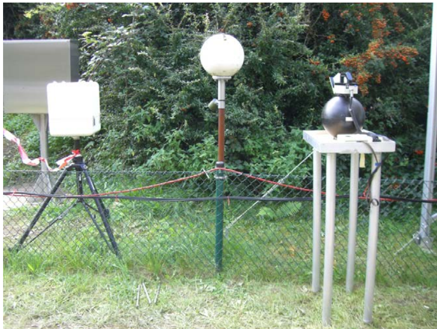
Abbildung 10: Messaufbau mit dem von der PTB eingesetzten Neutronen-Ortsdosisleistungsmessgerät LB6411 zusammen mit dem Anzeigerät/Datenlogger UMo LB123 (rechts) in unmittelbarer Nähe der Neutronendosis-Messstelle Nr. 12 (weiße Kugel). Der weiße Quader auf der linken Seite ist ein Messgerät für Gammastrahlung.
