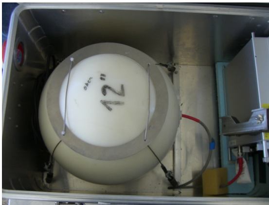
Abbildung 2: Messaufbau mit NEMUS am nördlichen Zaun des TBL. Links: Blick in eine geöffnete Aluminiumkiste mit der 12" Kugel mit eingebautem ^3\text{He} Zähler und Elektronikmodul. Rechts: sechs parallel betriebene Kugeln in Aluminiumkisten unter dem Zelt, direkt am Zaun in 1 m Höhe über dem Boden. Auf dem Bild zusätzlich zu sehen: Kabeltrommeln für die Stromversorgung der Elektronikmodule (unter den roten Plastikplanen), links die 30 cm Messkugel des NLWKN (Messstelle Nr. 12) und im Hintergrund der PTB LB6411 (unter der blauen Plastikplane).
