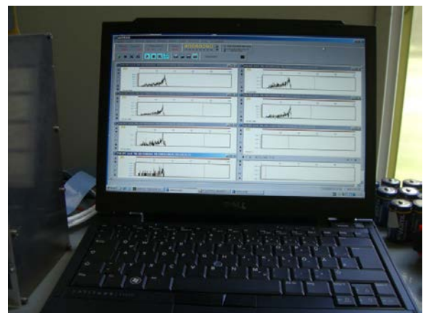
Abbildung 3: Messaufbau mit NEMUS am nördlichen Zaun des TBL (Fortsetzung). Links: Module für die Datenaufnahme im Messhaus 2: zwei 4-fach ADC, ein Vielkanalanalysator pro Datenzweig inkl. Ethernet-Switches. Rechts: Notebook mit dem Display von 6 Pulshöhenspektren.
