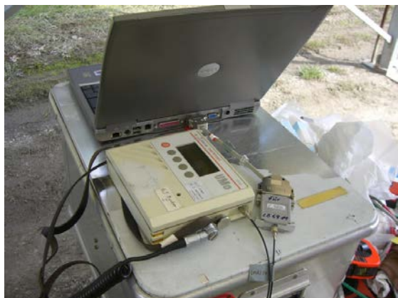
Abbildung 12: Links: Anschluss des Anzeigeräts/Datenlogger UMo LB123 über eine optische RS232 Schnittstelle an einen Laptop. Rechts: Anzeige der transferierten Daten auf dem Laptop-Monitor.
