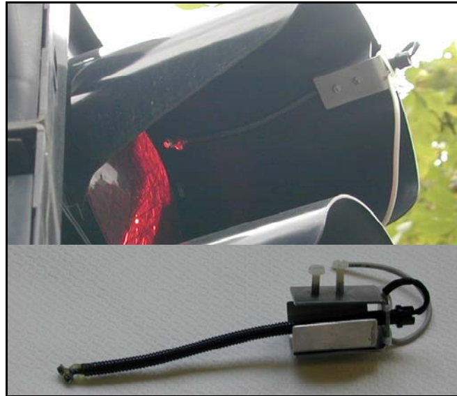
Bild 21: Sonde zur Erfassung der Ampelschaltungen (Eigenentwicklung IER)
