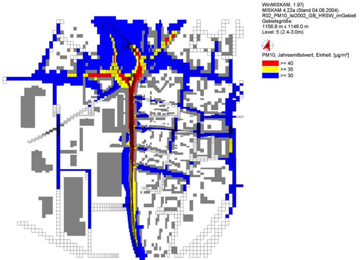
Abb. 4: Istsituation PM10-Konzentrationsfeld / unten Abb. 5: Maßnahme 1
